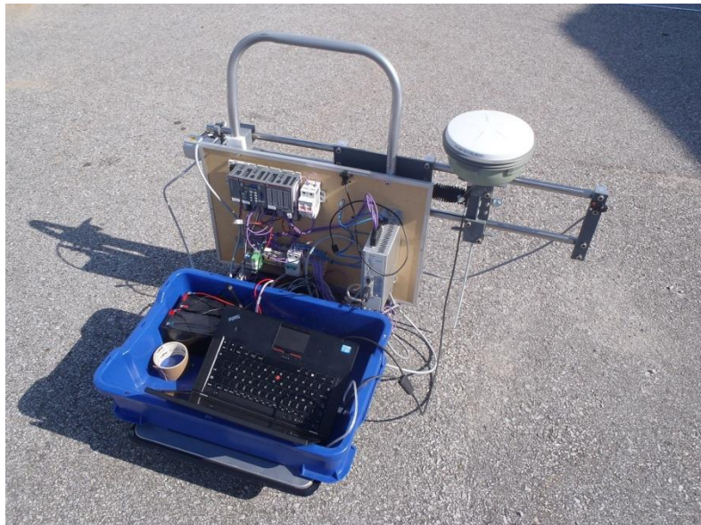
Bild 3, Testvagn för GPS-inmätning Fas1
