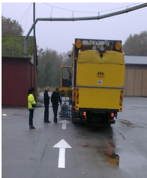
Bild 7, Maskinell vägmarkering av symboler kompatibel med GPS-indata
